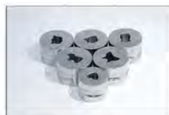
冲杆专用检验工装，保证模具的精准度。
